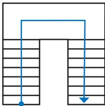
Typ F Zweiläufig gegenläufige Treppe mit Zwischenpodest, Änderung der Laufrichtung um 180°
