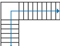
Typ H Zweiläufig gewinkelte Treppe mit Zwischenpodest, Änderung der Laufrichtung um 90°
