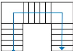
Typ G Dreiläufig zweimal abgewinkelte Treppe mit 2 Zwischenpodesten
